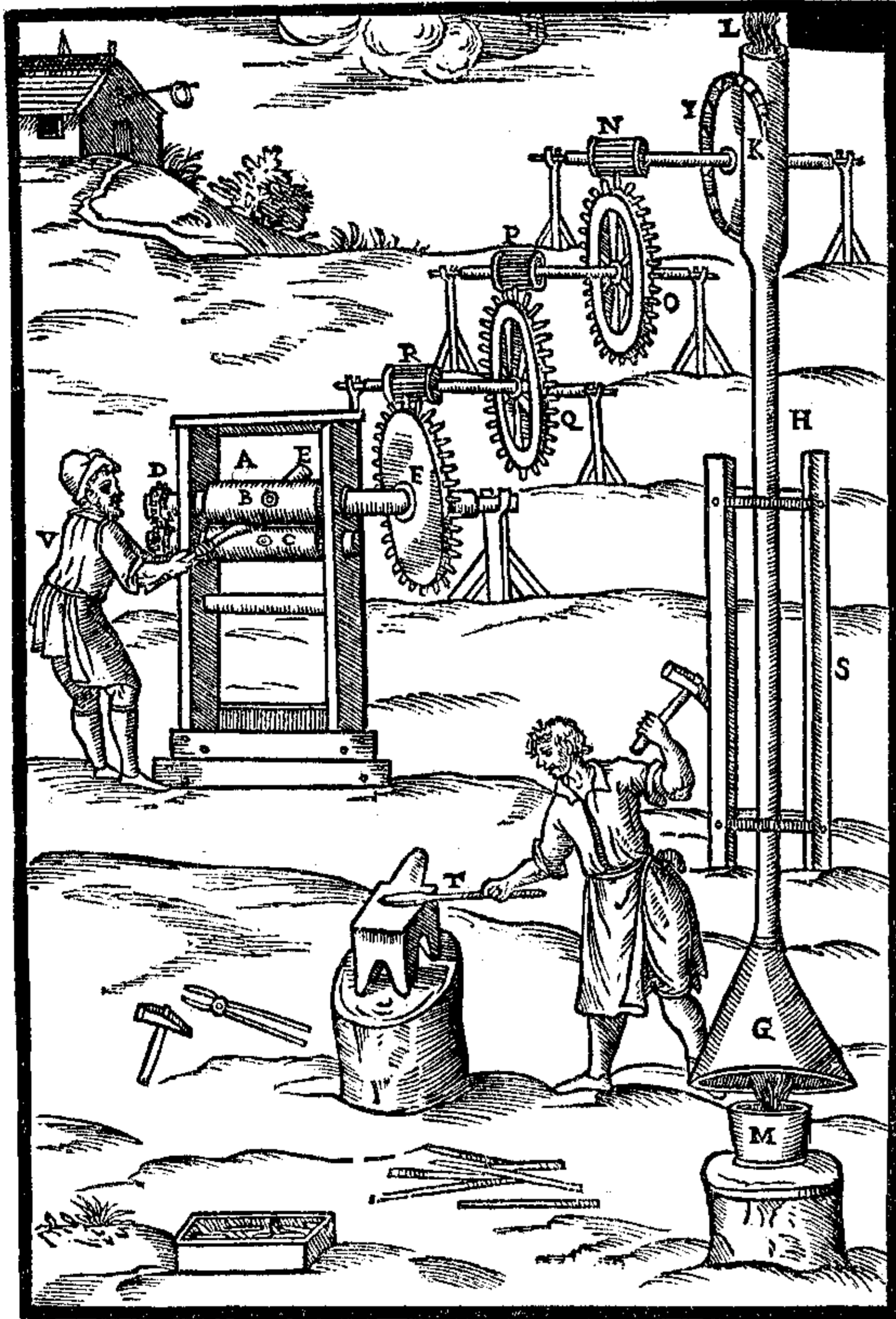
71. Прокатные валки начала 17-го столѣтія. По Branca.
